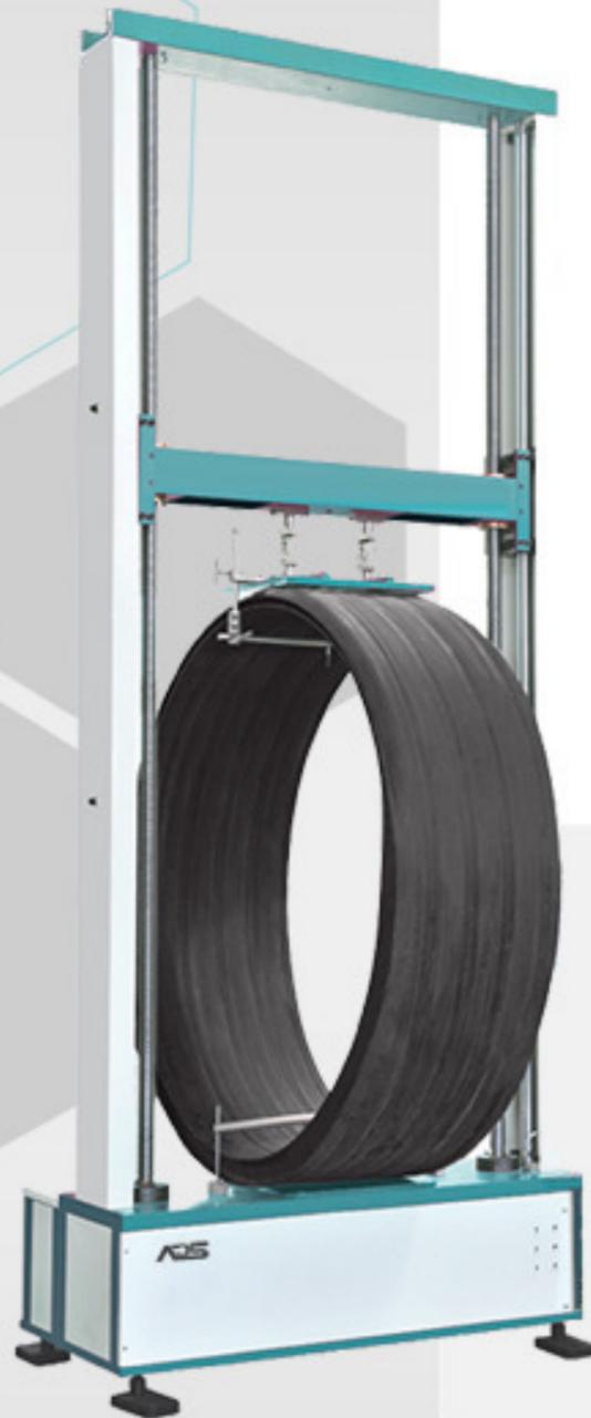
دستگاه استحکام حلقه ای (Ring stiffness) لوله های ترموپلاستیک با ظرفیت - 50kn (5000kgf)
